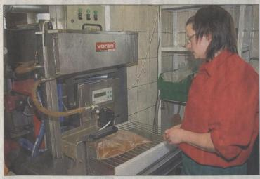
Nach dem Pasteurisieren wird der Saft noch heiß maschinell in doppelwandige und sterile Folienbeutel (bags) abgefüllt.
